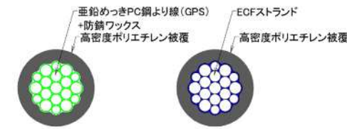
左: PE被覆ワックス垂鉛めっきPC鋼より線(三重防食) 右: PE被覆 ECF ストランド(二重防食)
